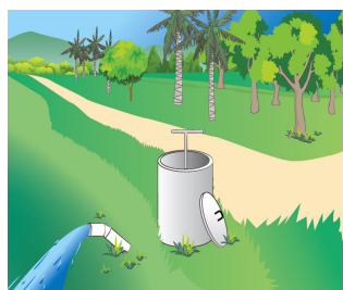
ท่อระบายตะกอนทราย
